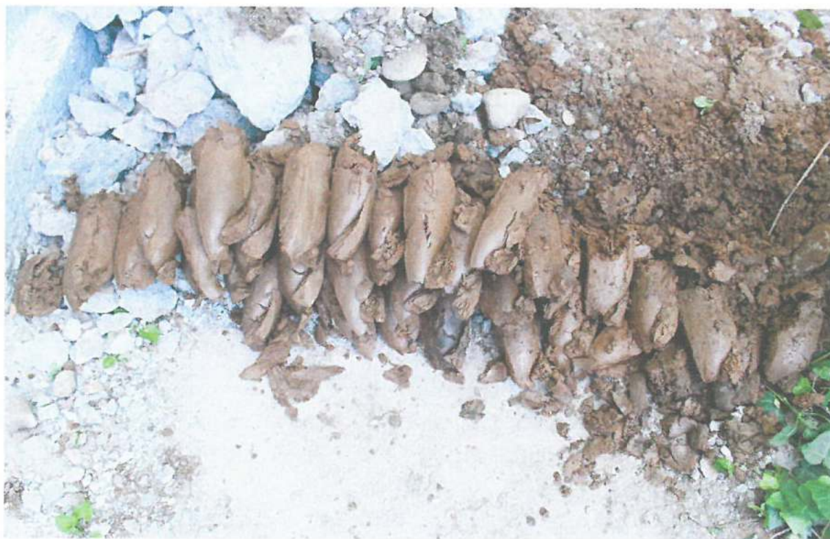
Foto 2 – Succesiunea litologica interceptată în forajul geotehnic
